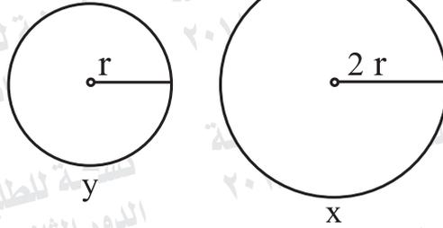
8- في الشكل التالي حلقتان معدنيتان من سلك مقاومته الأومية مهملة في مستوى واحد يؤثر عليهما مجال مغناطيسي متغير الشدة بمعدل منتظم في اتجاه عمودي على مستواهما. فإن النسبة بين القوة الدافعة الكهربائية المستحثة المتولدة في الحلقة (Y) إلى القوة الدافعة الكهربائية المستحثة المتولدة في الحلقة (X) تساوي:
