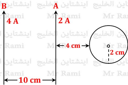
(29) في الشكل المقابل : كانت شدة التيار الكهربائي المار في الملف الدائري  $\frac{1}{6\pi} A$  عندما كانت كثافة الفيض المغناطيسي عند مركزه تساوي صفراً ، حدد اتجاه التيار الكهربائي المار في الملف ثم احسب عدد لفاته .
