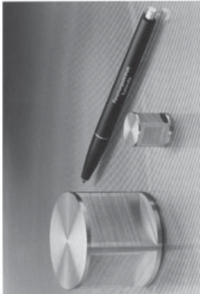
112 Industrievorteil der Zukunft? Mikrorezeiter „Erkoster Wölfl“ – Chemiefabrik am Südrhein MEMS- und Nanotechnologie könnten es ermöglichen, viele industrieller Grundstoffe zu miniaturisieren und den Flächenbedarf der Industrie zu verringern, auch wenn es in der Zukunft sicherlich keine Fabriken „in Postkartengröße“ geben wird. Für Analysezwecke sind dünnere Chips in der Entwicklung, die vielleicht einmal ganze Gradlabore ersetzen können. Die US-amerikanische Firma Agilent Technologies bietet bereits Chips an, die mit einem Durchmesser von 100 µm bester auskommen: Werkstätten der Zukunft? Ein Forschungsunternehmen befindet sich in der Entwicklung einer Innovation im Bereich der Mikroelektronik – bietet bei einem Rauminhalt von 1 cm 3 Platz für 4.000 haarteile fähigen. Durch „etwas größerer“ Würfel mit kantentragigen von 3 cm können in einer Stunde 7.000 Flüssigkeit gepumpt werden, was industriellen Anforderungen entspricht. Aufgrund der außergewöhnlichen Eigenschaften der Minisatelliten lassen sich die verwendeten Bauelemente, insbesondere wirtschaftlich nutzen. Durch die geringere Größe der Bauelemente sind die Kosten der Herstellung erheblich niedriger. Dies führt zu einer Reduzierung des Energieverbrauches und des Materialverbrauches sowie zu einer Erhöhung der Lebensdauer der Bauelemente.
