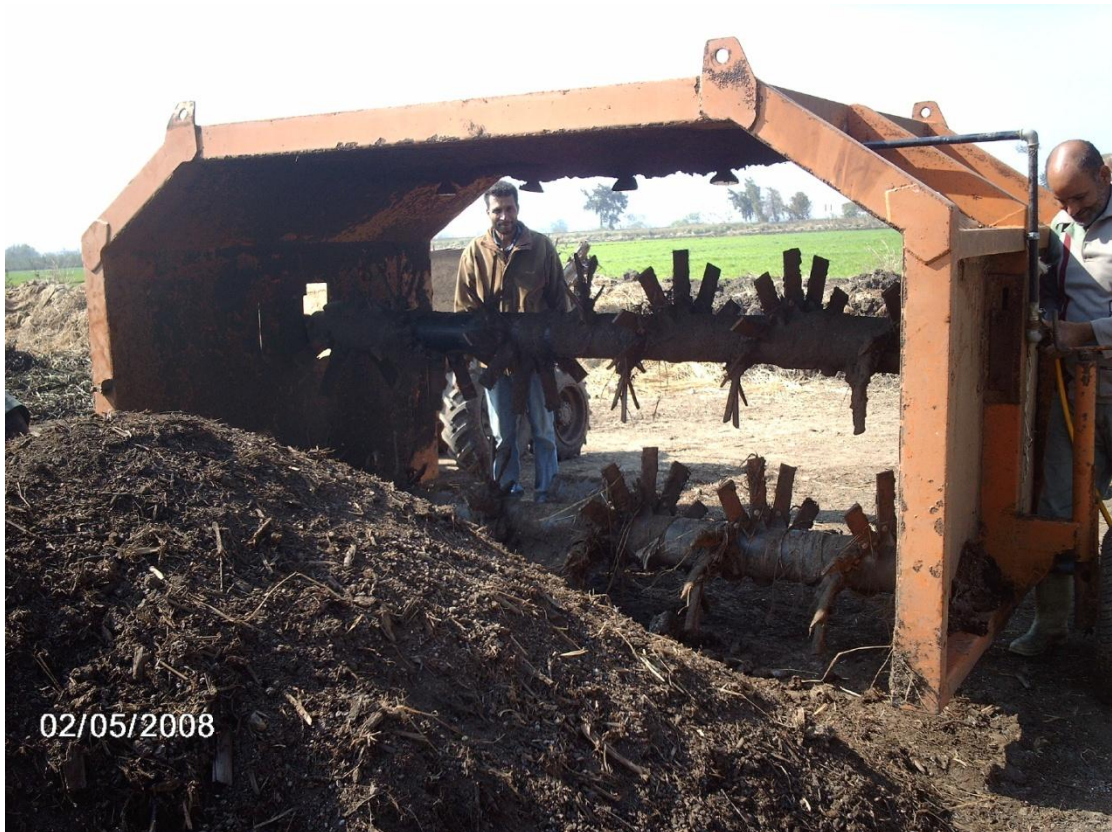
آلة تقليب الكومة السمادية (ذات درفيلين)
