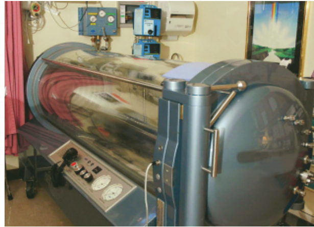
الشكل 1 أثناء HBOT يرقد المريض في غرفة الضغط العالي. يتحكم الفني في مستويات الضغط والأكسجين.
