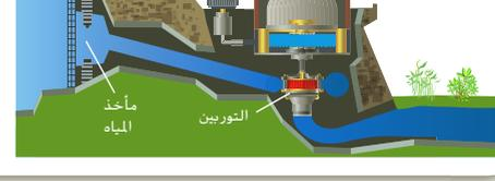
■ **يوضح الشكل 2** إمكانية تغير الطاقة من شكل إلى آخر ولكن مع الاحتفاظ بها دومًا. في **a** تم تحويل طاقة وضع الماء إلى طاقة حركية حيث تسقط خلال سحبيها من مكانها المرتفع في الخزان. يؤدي الماء المندفق إلى دوران التوربينات لتوليد الطاقة الكهربائية. في **b** يتم تحويل طاقة الوضع المخزنة في روابط جسيمات البروبان إلى حرارة.
