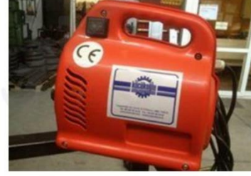
Elektrikli Beton Vibratörü رجاج بيتون كهربائي
