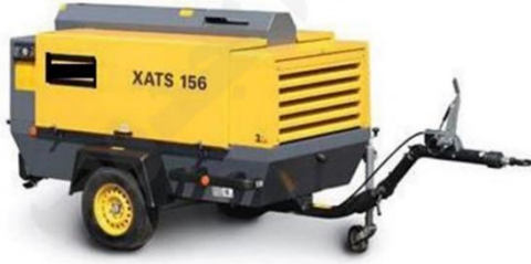
Hava kompresörü (mobil) كومبرسور هواء - ضاغط هوائي. متنقل
