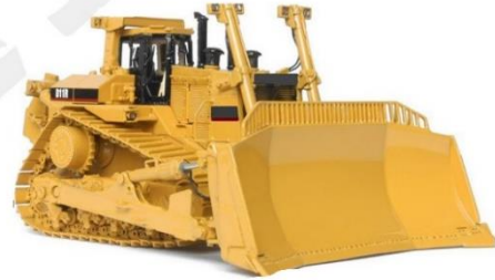
Üçgen paletli dozer بلدوزر مع شفرة ثلاثية الجوانب
