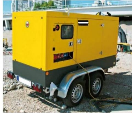
Jeneratör (mobil) مولدة كهرباء متحركة
