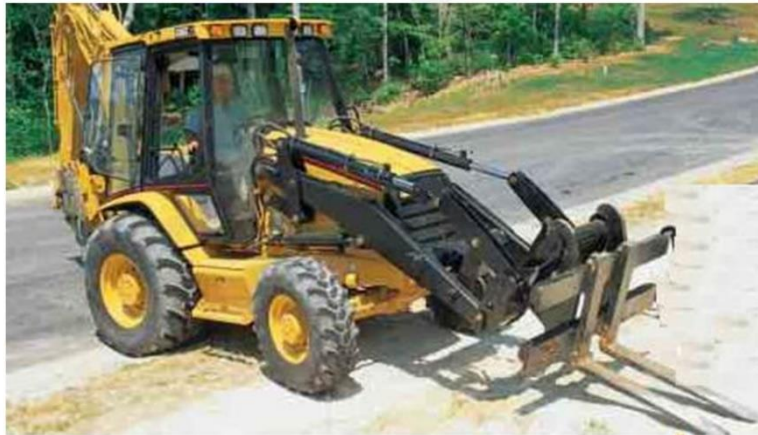
Makinenin Forklift Gibi Kullanılması ستافة
