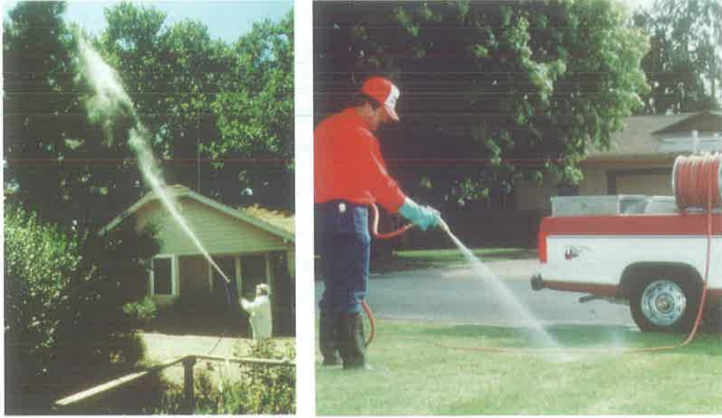
شكل (٩ - ٢٢): تنتج مسدسات الرش اليدوية (مدافع الرش اليدوية) عادة رش أو تدفق عالي الضغط، وتستخدم لتطبيق المبيدات الحشرية والفطرية على الأشجار والشجيرات، وتستخدم أيضاً لرش المناطق المائية، والمواشي، والمباني، وأطراف الطرق.
