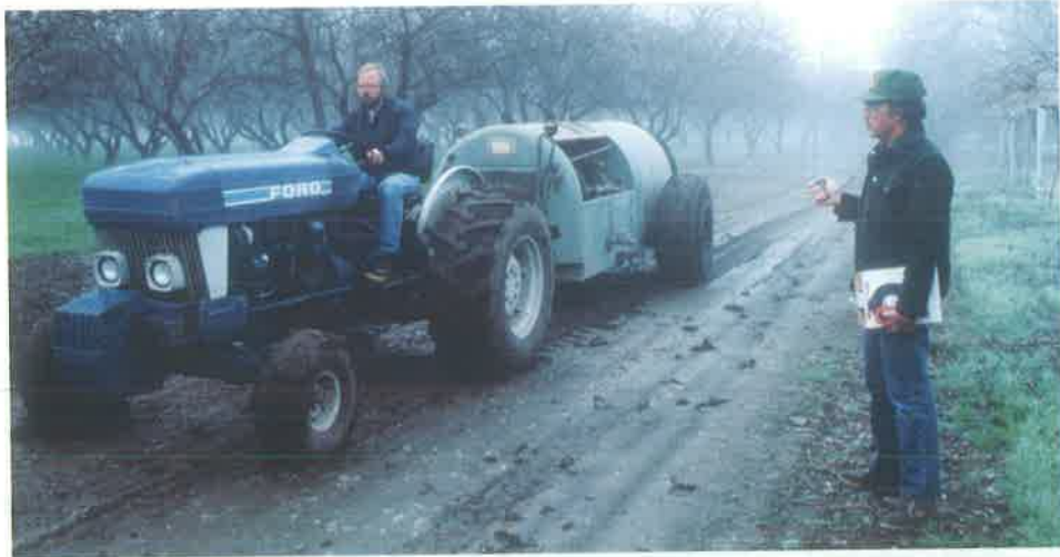
شكل (١٠ - ٣): قم بقياس مسافة محددة عندما تحسب سرعة انتقال أو تحرك معدات التطبيق. استخدم ساعة توقيت لتحديد وقت انتقال المرش ضمن حدود المسافة المقاسة.
