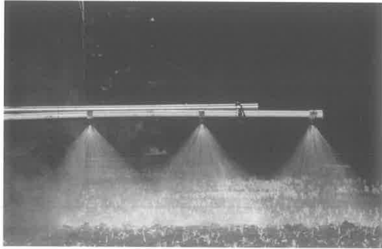
شكل (٩-١٣): تتحكم بشابير (بخاخات) الرش بمعدل الاستخدام (التطبيق) وحجم القطيرة والانتظام (التماثل) والشمولية وأمان تطبيق المبيدات.
