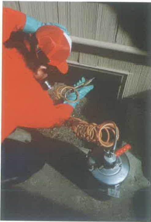
شكل (٩ - ٤٧): يمكن أن يستعمل عفار الهواء المضغوط لتطبيق مساحيق المبيدات في المناطق المغلقة، فجوات (فراغات) الحيطان، وأماكن الزحف الواقعة تحت أرضية المنزل، والعليات (أماكن واقعة تحت سطح المنزل مباشرة).
