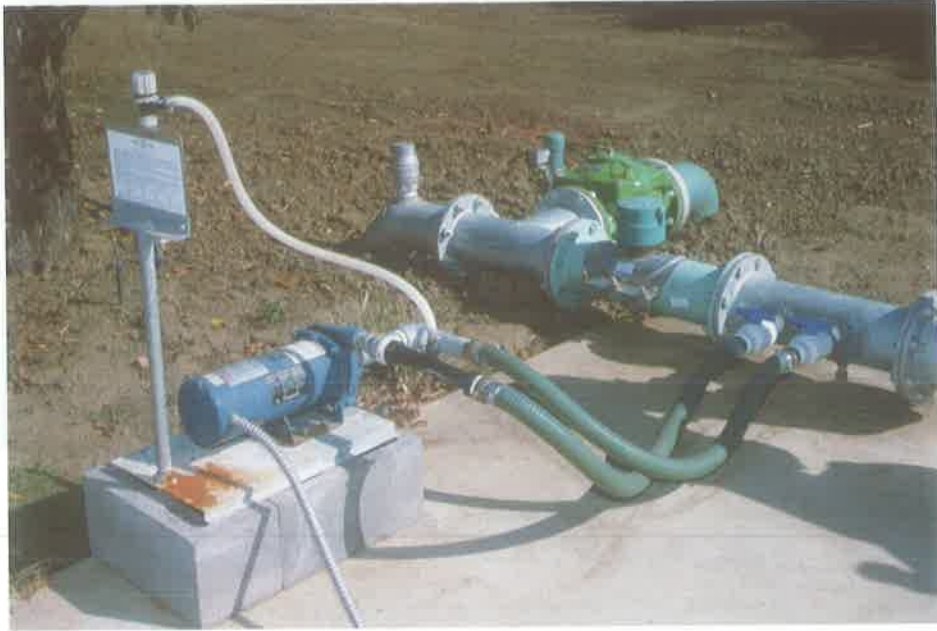
شكل (٩ - ٤٥): تستخدم مضخات الحقن الصغيرة لحقن المبيدات داخل ماء الري، وتعرف هذه التقنية بالري الكيماوي Chemigation.
