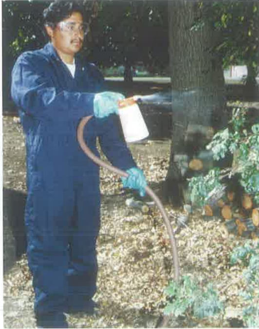
شكل (٩ - ٣٠): تستخدم موزعات الايروسولات في الاستعمالات أو التطبيقات التجارية وتكون متصلة بخراطوم وقضيب الرش والتي تمكّن القائم بتطبيق المبيد بحقن السوائل داخل الشقوق والفراغات.
