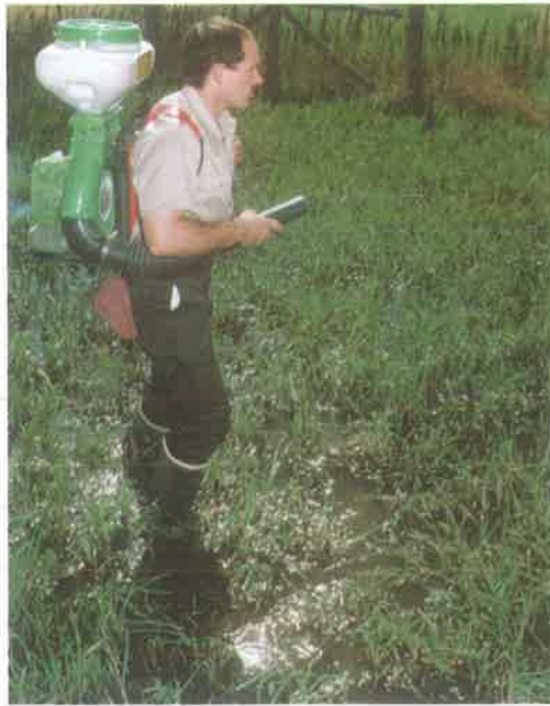
شكل (٩ - ٥٠): يمكن أن تستعمل المواد الحبيبية بواسطة موزع الحبيبات الظهرية. حيث يزود موتور بنزين صغير الطاقة للمروحة التي تنشر المواد الحبيبية.
