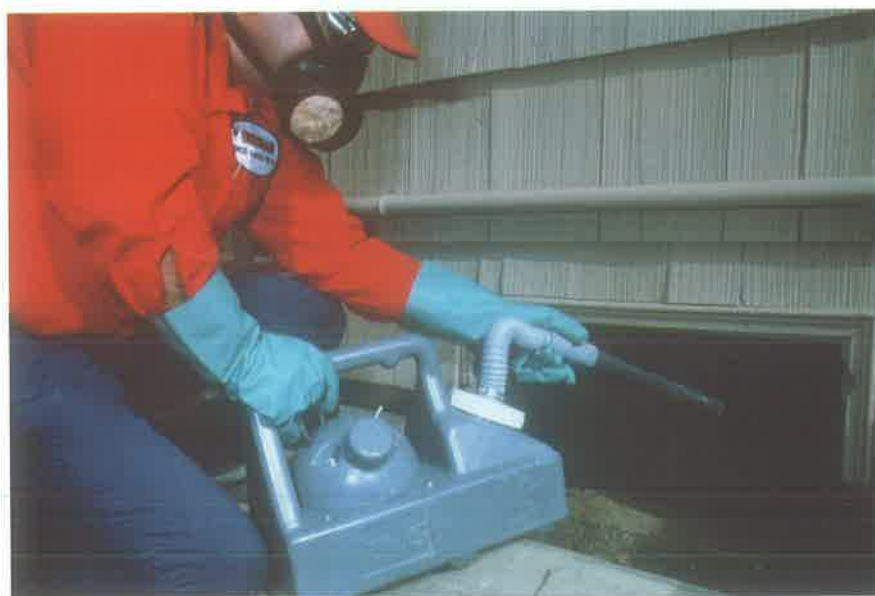
شكل (٩ - ٤٨): تستخدم العفارات ذاتية الطاقة في نشر مسحوق التعفير داخل المناطق المحدودة (المحجوزة) ولهذه العفارات مروحة لحمل مسحوق التعفير إلى الأسطح المرغوب معاملتها.
