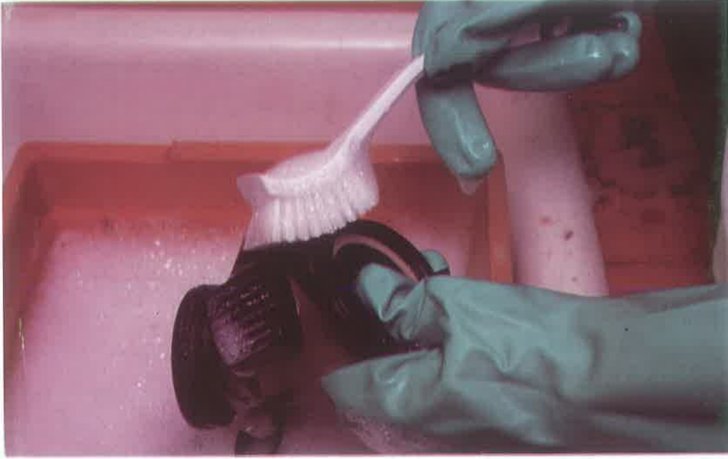
شكل (٦ - ٢٧): قم بإزالة الخراطيش واغسل الكمامات بمياه دافئة محتوية على الصابون. وكما هو معروض هنا، إستخدم فرشاة مرنة أو قطعة قماش لإزالة متبقيات المبيدات.
