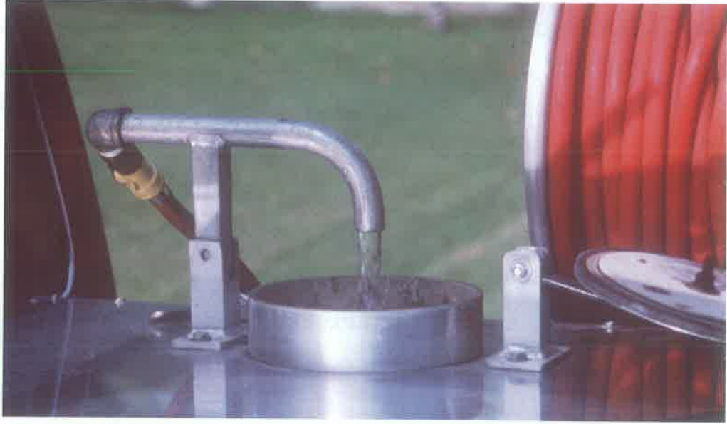
شكل (٦ - ٤٤): عندما يراى ملء خزان الرش من الأعلى تأكد بأنه يوجد فراغ هوائى بين أنبوبة (ماسورة) ملء الخزان والحد العلوي للماء داخل الخزان. وهذا سيمنع التدفق العكسي للمياه الملوثة بالمبيدات إلى داخل مخزون المياه.
