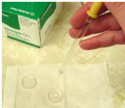
شكل (105): وحدة وضع العينة في جهاز طيف الأشعة تحت الحمراء
