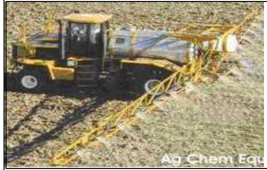
شكل ( 68 ) : المرشة الحقلية ذات الحجم والضغط العالي
