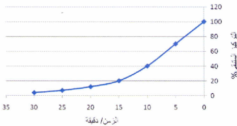
شكل رقم 3: تركيز السماد في ماء الري مع الوقت عند استخدام تلك السمادة
