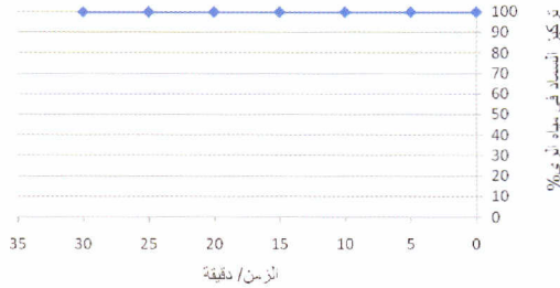
شكل رقم 7: تركيز السماد في ماء الري مع الوقت عند استخدام حاقنة الدوزاترون
