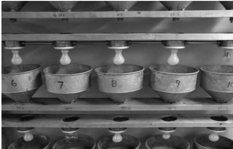
الشكل (4-4) وحدة لنظام قمع بيرليزي لاستخلاص الآكاروسات من العينات المختلفة (تصوير Lyle Buss، جامعة Gairiesville، فلوريدا)
