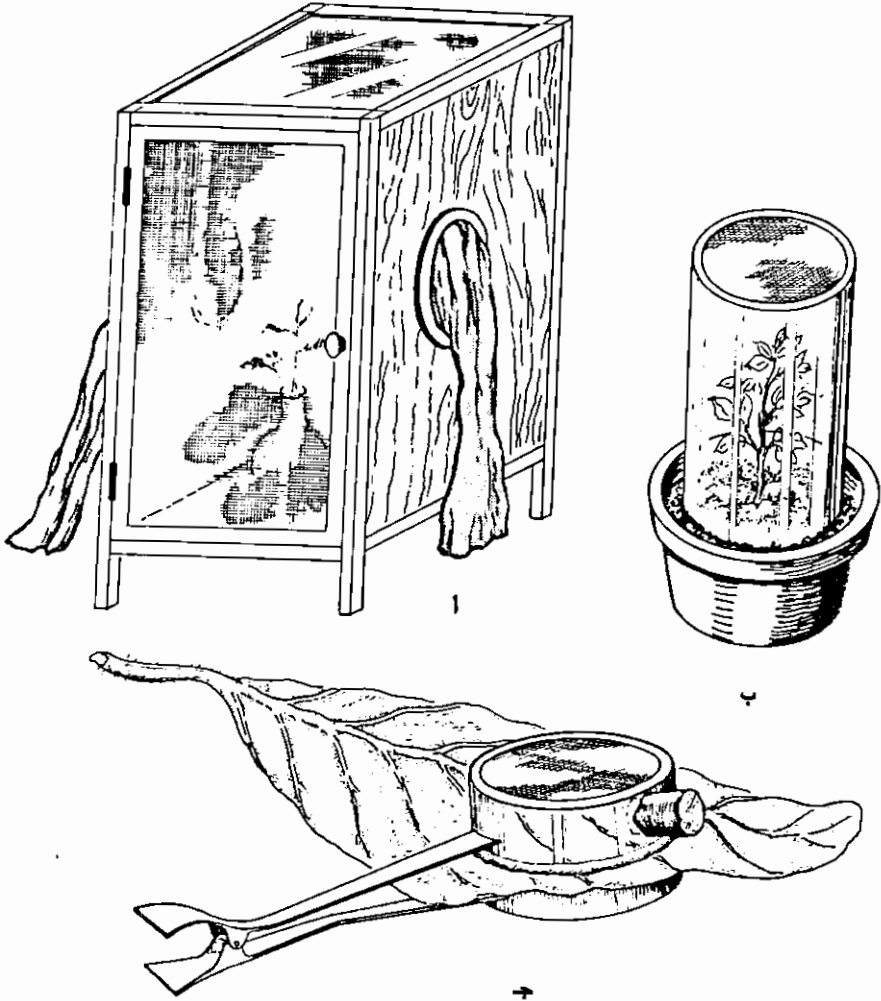
شكل (٤-٥) : أشكال الحجيرات المستخدمة في اختبارات الانتقال الحشرى للفيروسات : (١) حجيرات خشبية ، و (ب) حجيرات بلاستيكية اسطوانية ، و (ج) حجيرات الأوراق . (٢) حجيرات الأوراق الأسطوانية البلاستيكية Plastic Cylinder Leaf Cage .
