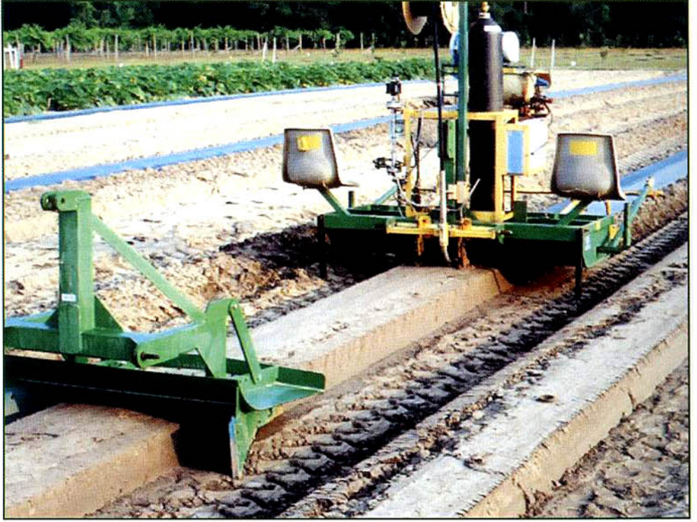
شكل رقم (٦). آلة واحدة تقوم بإنشاء الخط والتغطية بالغطاء البلاستيكي وتلحيمة في آن واحد عن: Hochmuth, 2003 [26]
