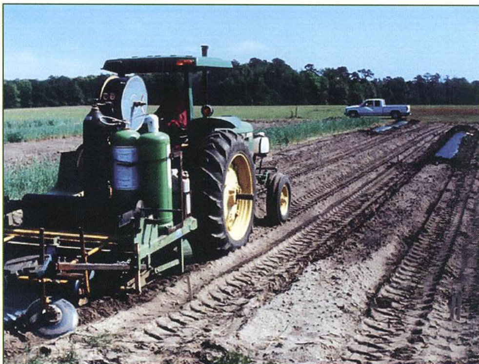
شكل رقم (٧). صاحب زراعي مزود بألة واحدة تقوم بحقن المبيد المدخن وضغط التربة لإنشاء الخط ثم التغطية بالغطاء البلاستيكي وتلجيمه في آن واحد عن: Hochmuth, 2003 [26]
