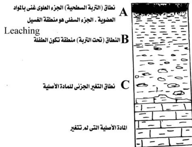
شكل ٦ ب مقطع جانبي للتربة يوضح النطاقات A ، B ، C
