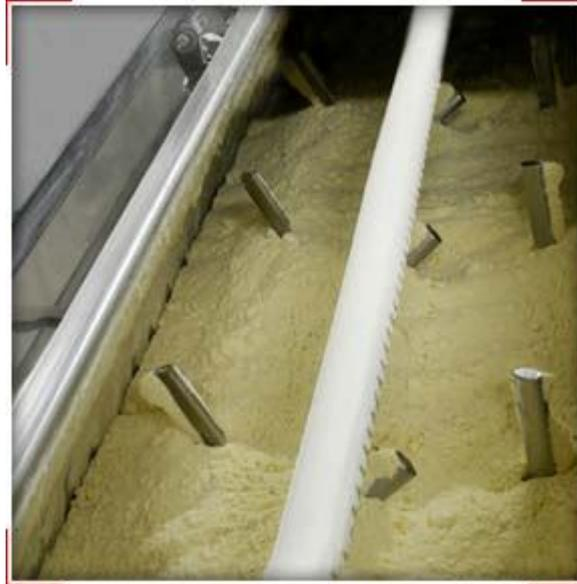
شكل يوضح خطوة العجن أثناء صناعة المكرونة
