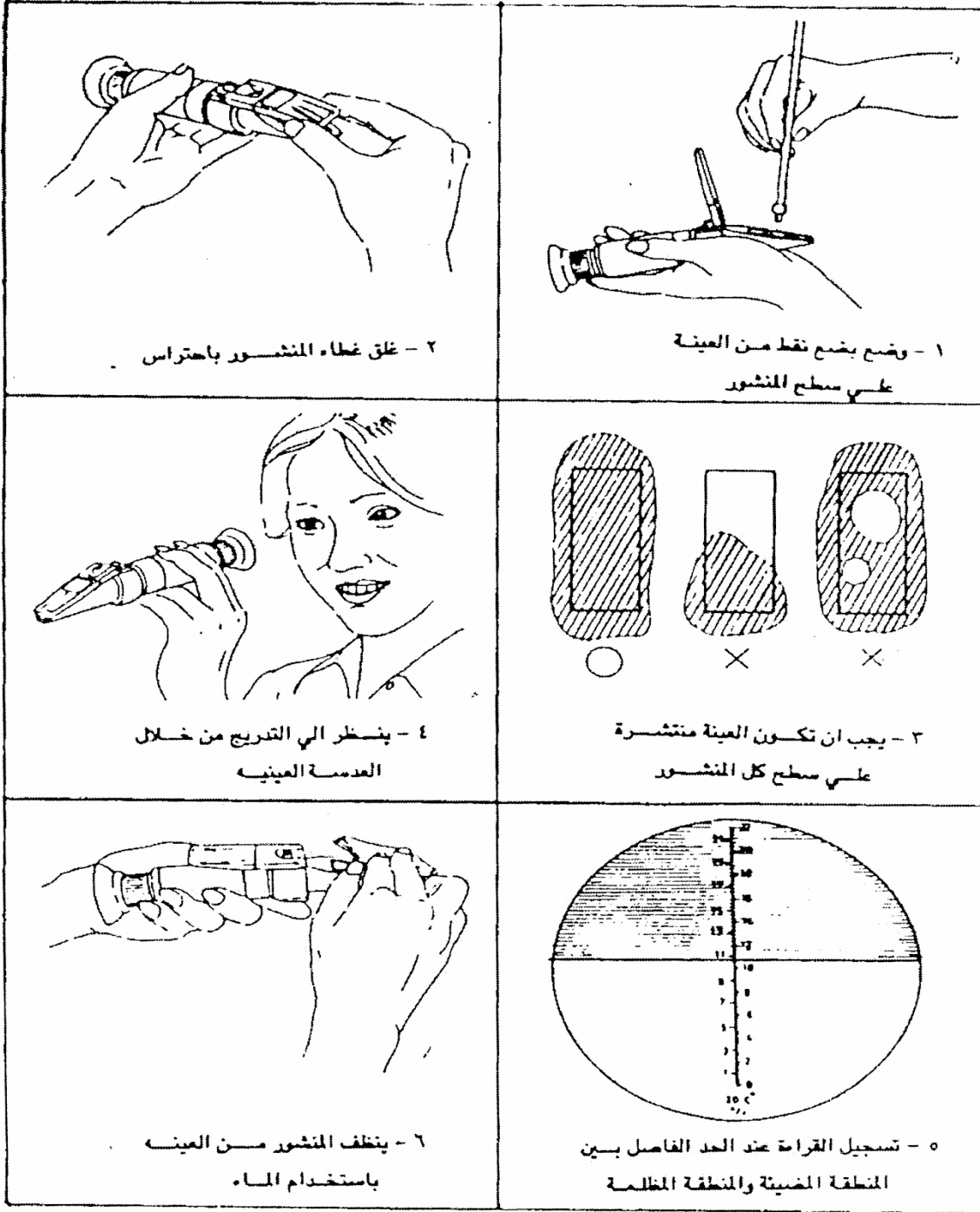
شكل (٣٤) خطوات العمل لقياس تركيز محلول باستخدام الرفراكتومتر اليدوي
