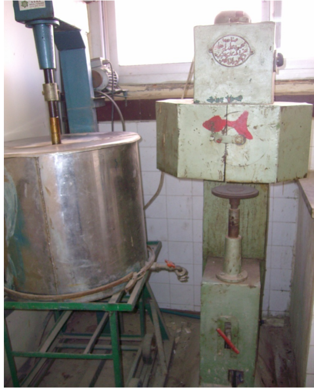
شكل (٦) ماكينة لقفل العلب الصفيح وحلة طبخ المربي مزودة بمقلب
