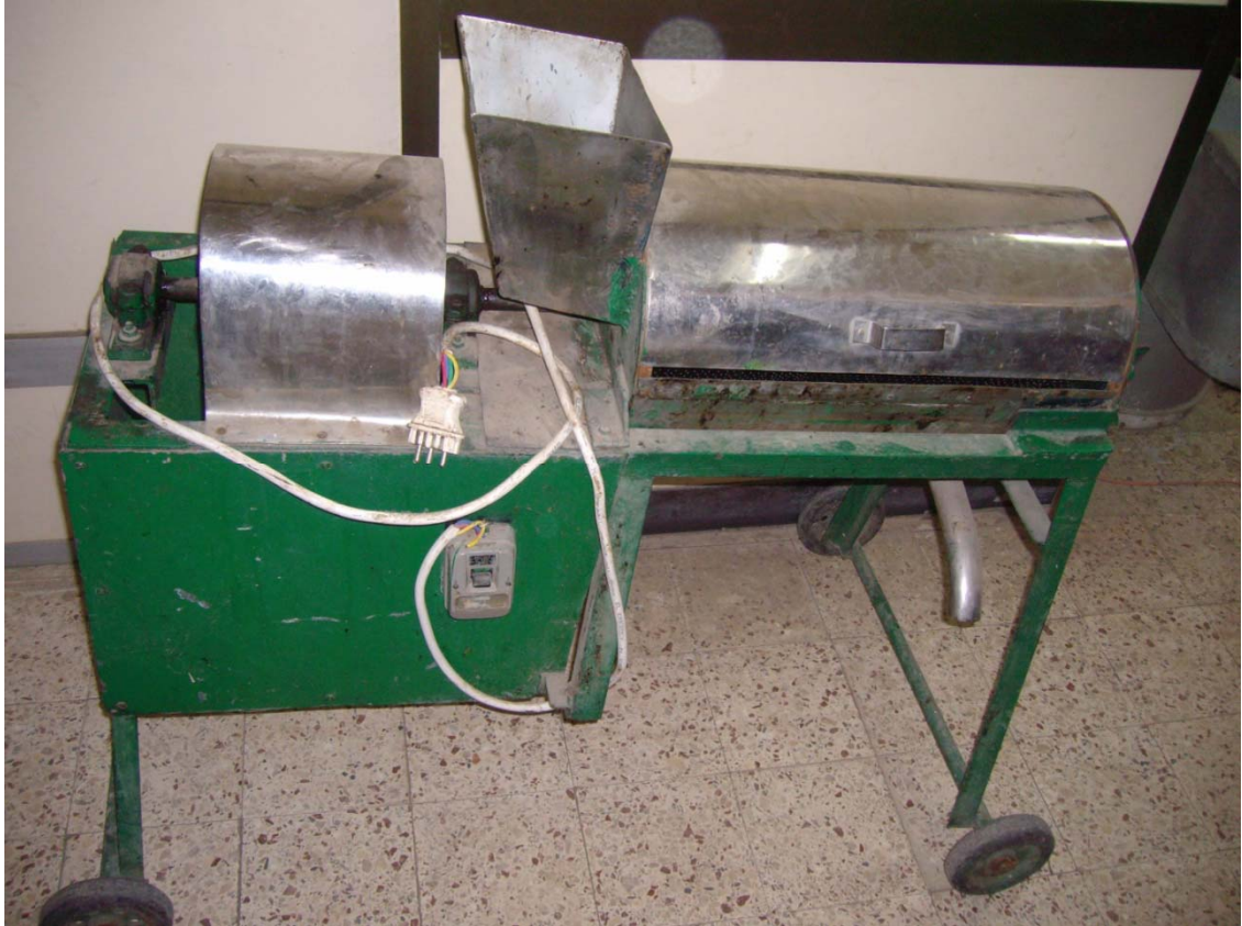
شكل (١٢) ماكينة لاستخراج بعض أنواع العصير
