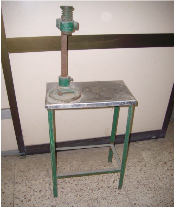
شكل (٨) ماكينة لقفل العبوات الزجاجية (عبوات الشراب والمياه الغازية)
