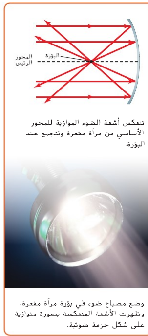
الشكل 11 في حال تتبع مسار الأشعة الضوئية من البؤرة إلى المرآة، ستنعكس عن السطح كأشعة متوازية.
