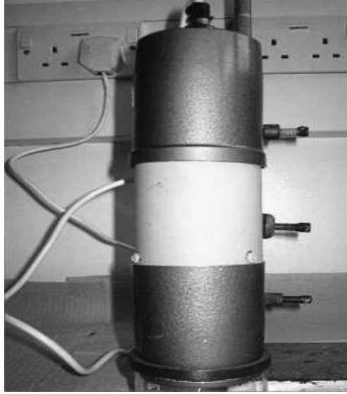
الشكل (5-6) قمع توليكرن لاستخلاص الحشرات من التربة.
