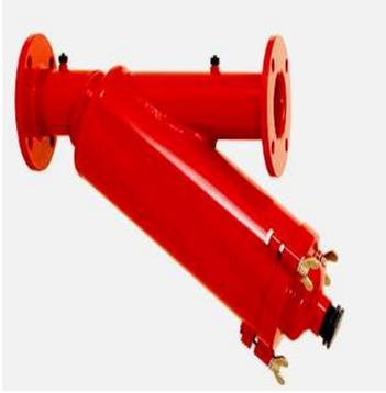
تستخدم الفلاتر الشبكية في حالة استخدام مياه الآبار. وهي من أكثر الطرق استعمالاً لإزالة المواد الصلبة العالقة بالمياه وهذه الشبكة إما أن تصنع من السلك أو النايلون. وتعتمد قدرة الفلتر الترشيحية على قطر الفتحات بالشبكة أو عدد الفتحات في البوصة المربعة.
