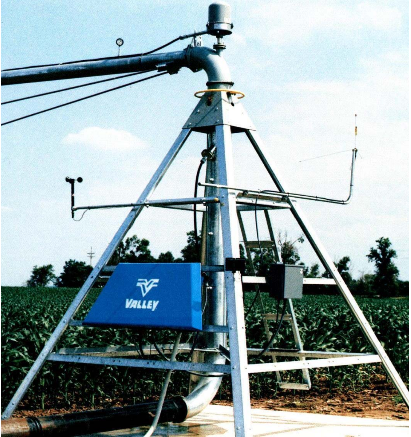
شكل (٤ - ١) قاعدة نظام الري بالرش المحوري
