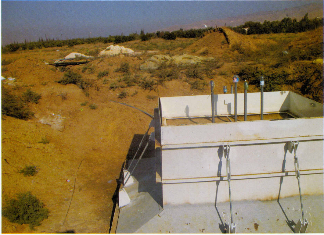
شكل (١٢) وضع دعائم لحماية الجهاز من ضغط التربة الجانبية للايزوميتر
