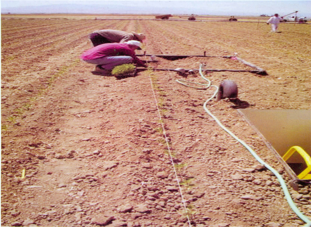
شكل (١٤) تمديد شبكة الري والزراعة داخل اللايسميتر
