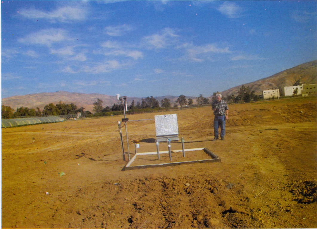
شكل (١٣) تركيب محطة رصد جوي بجانب جهاز اللايزوميتر
