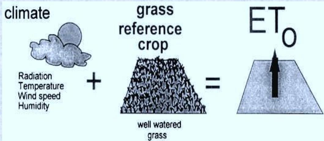
شكل 7: مكونات عملية التبخر الزراعي للمحصول المرجعي [3].
