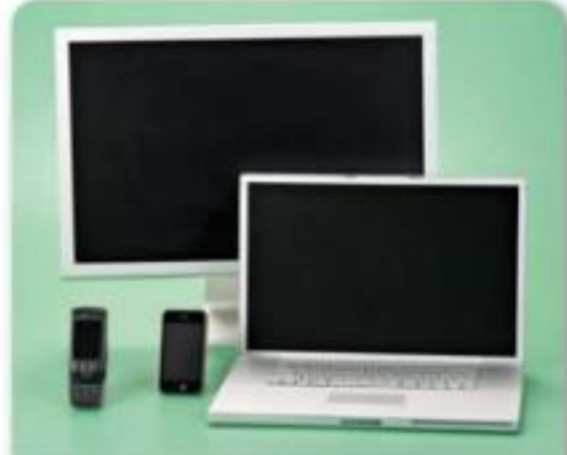
الشكل 12 تستخدم الكثير من أجهزة الموسيقى والإلكترونيات الصغيرة مثل عَشَمَلَات MP3 والهواتف المحمولة وأجهزة التلفزيون والحواسيب المحمولة الصغيرة (أنت بوك) شاشات بلورات سائلة (LCD).
