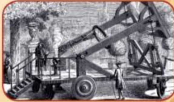
الشكل 1 تركب عدسات هذا الجهاز العملاق ضوء الشمس، مما أنتج حرارة كافية لحرق الألباس.
