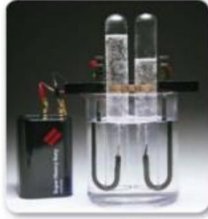
الشكل 16 إنَّ الماء مستقر، لكن عند تمرير تيار كهربائي خلاله، يتحلل الماء لينتج الهيدروجين والأكسجين.
