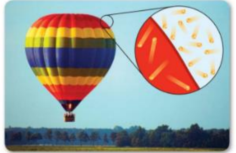
الشكل 9 عند تسخين الهواء الموجود داخل بالون الهواء الساخن، تتحرك جسيماته بعيدًا بعضها عن بعض، ويرتفع البالون لأنّ الهواء الموجود بداخله أقل كثافة من الهواء المحيط به.
