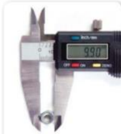
الشكل 11 يُستخدم المقياس العكسي الرقمي للتحقق من حجم صامولة حتى جزء من المئة من المليمتر (0.01 mm). إن المهارة المطلوبة لتحديد وضع الجزء في المقياس العكسي بصورة صحيحة، سيحصل الميكانيكيون أصحاب الخبرة على قراءات أكثر دقة من الميكانيكيين غير الخبراء.
