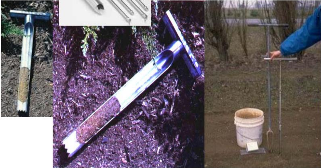
شكل (٣) أنواع بريمات التربة المختلفة.
