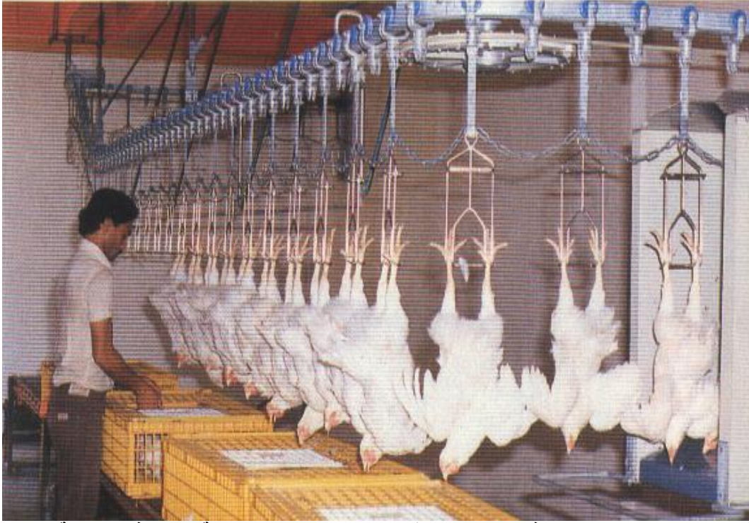
الشكل رقم (20) يقوم العمال باخراج فروج اللحم من اقفاص النقل وتعليقه من منطقة الارجل في السلسلة المتحركة بحيث يتدلى الراس الى الاسفل . و يلاحظ شكل السلسلة المتحركة والعجلات التي تدير عليها السلسلة على عتلات حديدية معلقة بسقف المجزرة .
