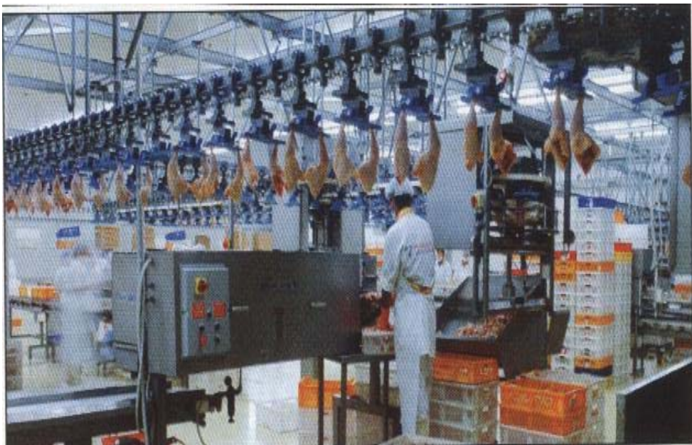
الشكل رقم (35) ماكينة التقسيم او التجزئة الأتوماتيكية التي تقوم بفصل الأفخاذ والاجنحة من منطقة الصدر والظهر للذبيحة .
