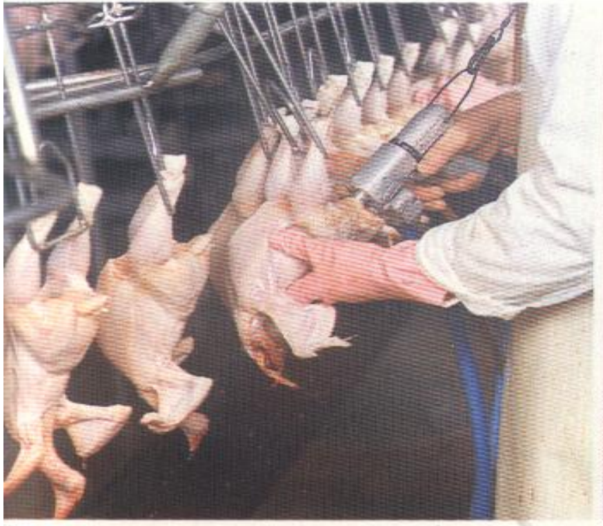
الشكل رقم (28) الآلة الخاصة بقطع المخرج (Vent gun) التي تقوم بعمل شق، او قطع دائري حول فتحة المخرج لتسهيل عملية اخراج الاحشاء كاملة، وفصلها عن الذبيحة .
