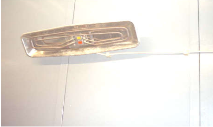
شكل رقم (٢٦٢) يوضح جهاز تدفئة خاص لتدفئة البيض قبل وضعة فى المفرخ
