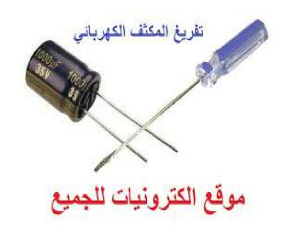
بعد التفريغ التام للمكثف المطلوب فحصه يضبط جهاز الأفوميتر على أعلى مقياس في خانة الأوم
