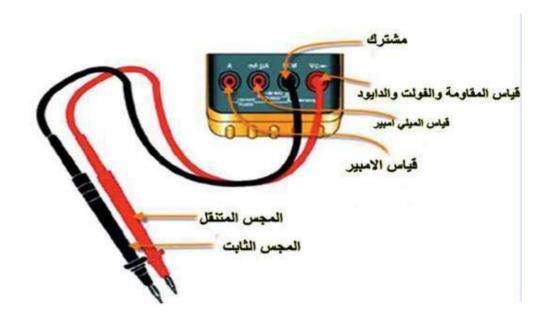
لهذا الجهاز يستخدم الطرفين + و COM عند قياس كل الكميات الكهربائية التي يمكن للجهاز التعامل معها
