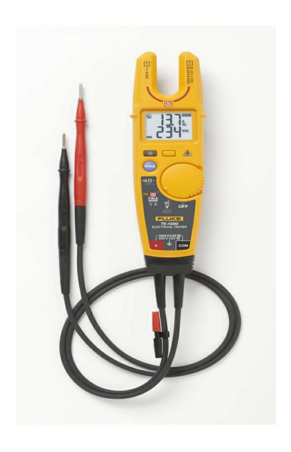
يتميز جهاز الفحص ذو المشبك المفتوح بإمكانية قياس الجهد المتردد حتى 1000V دون الاتصال بالنقاط الحية ودون فتح الأغطية أو المسامير
