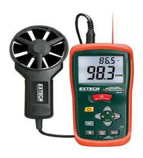
يستخدم لقياس سرعة الرياح مع اظهار درجة شدتها بالاضافة الى قياس درجة الحرارة يستخدم لقياس قدرة الاجهزة والمراوح في دفع الهواء
