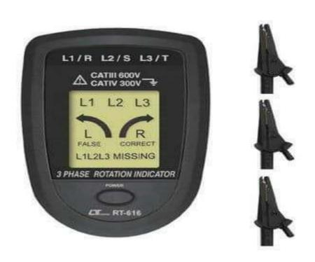
يستخدم هذا الجهاز عند توصيل المحركات ثلاثية الطور لتحديد اتجاه دوران المحرك
