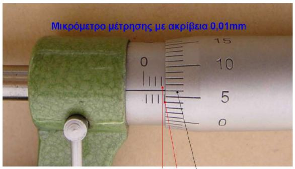
Μέτρηση: κύρια κλίμακα = 3,5 mm (3+0,5) + κλίμακα του τύμπανου = 0,06 mm Διάμετρος αντικειμένου = 3,56 mm
