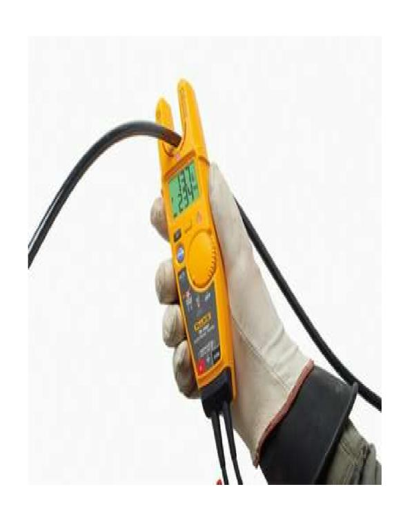
وامكانية قياس البسبارات النحاسية حتى 120 مم 2 و قياس التيارحتى 200A
