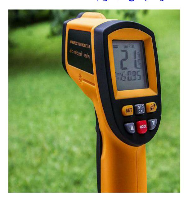
هو جهاز محمول يقيس الإشعاع الحراري يستخدم هذا القياس في تحديد درجة حرارة الجسم المشع أو بالأغلب درجة حرارة سطحه
