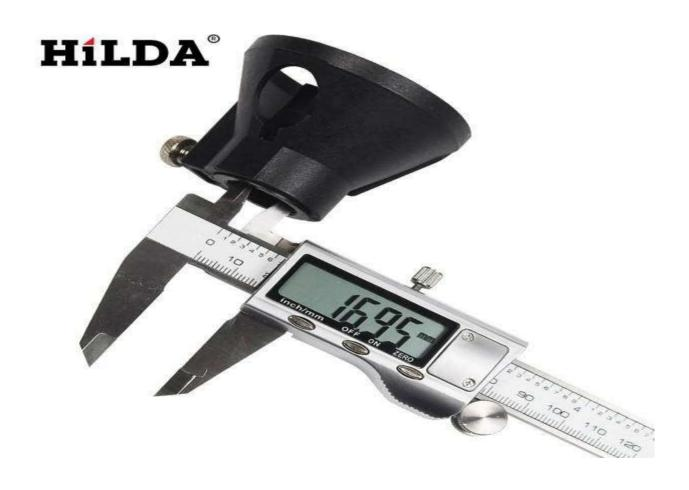
كما يمكن قياس عمق الثقوب في الأجزاء المعدنية أو الخشبية باستخدام الساق الرفيعة المرتبطة بالفك المتحرك وتنزلق على ظهر المسطرة الأساسية وتوافق بداية الساق حد المسطرة الأساسية في الوضعية الصفرية
