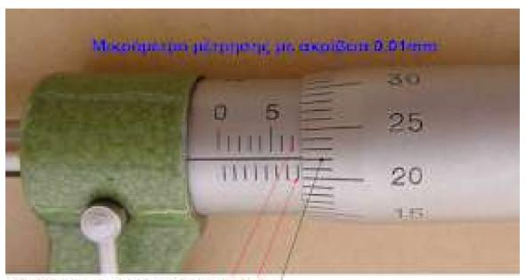
Μέτρηση: κύρια κλίμακα = 7,5 mm (7+0,5) + κλίμακα του τυμπάνου = 0,22 mm Διάμετρος αντικειμένου = 7,72 mm
