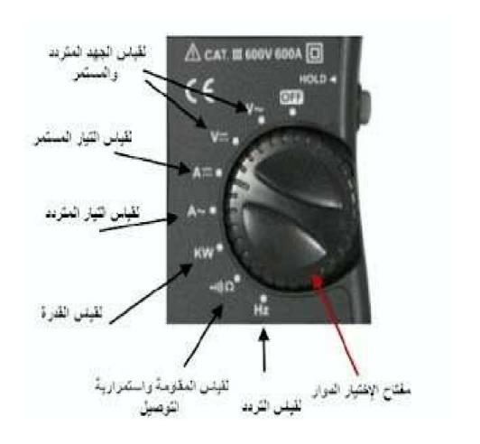
الوضع (OFF) ايقاف الجهاز الوضع (VV) لقياس الجهد المتردد الوضع (---V) لقياس الجهد المستمر الوضع (---A) لقياس التيار المستمر الوضع (A) لقياس التيار المتردد الوضع (A) لقياس التيار المتردد
