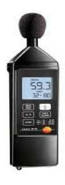
إن ديسيبل هو وحدة قياس تستخدم لقياس النسبة بين قيمتين
