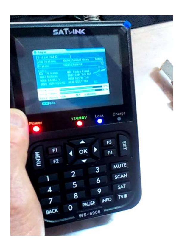
يستخدم هذا الجهاز لضبط اشارة القمر الصناعي بمقياس رقمي دقيق مع نبرة صوت في حال التقاط الإشارة وبشاشة رقمية صغيرة سهلة وواضحة بدون استخدام تلفزيون او ريسيفر
