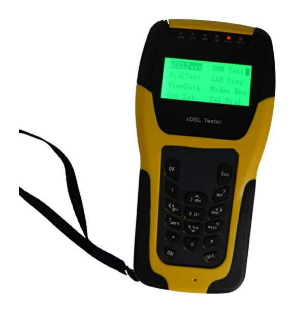
جهاز اختبار XDSL هو أداة اختبار متعدد الوظائف ومصمم خصيصًا لاختبار خط XDSL + ADSL - ADSL2 + ADSL + READSL - VDSL2
