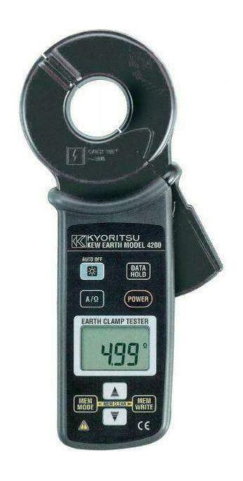
ومبدأ عمله قياس التيار المار في شبكة الأرضي ثم تحويله الى مقاومة وفق قانون اوم V+I=R
