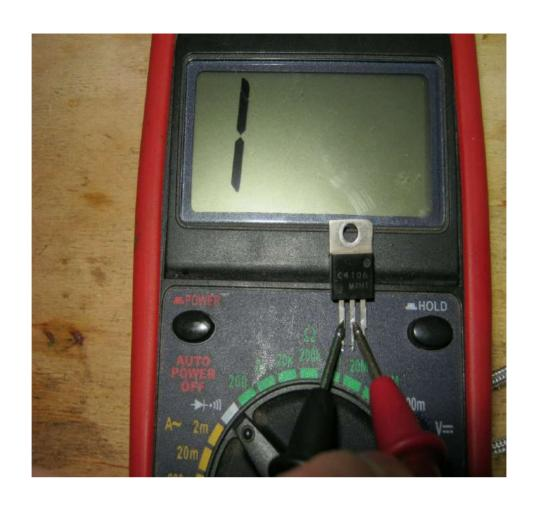
يوجد في بعض انواع الافوميتر مدخل خاص لفحص وتحديد الترانزستور
