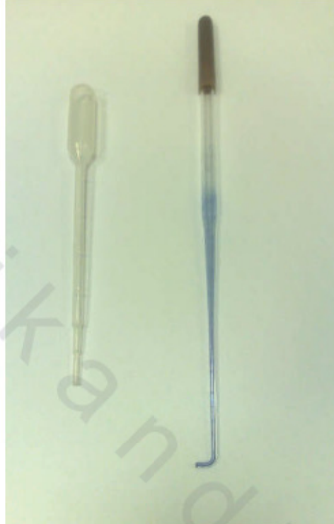
الشكل رقم (٤٦). يوضح ماصة باستير وماصة بلاستيك مطاطية لزوم تجارب قياس الجهد المائي للخلية.
