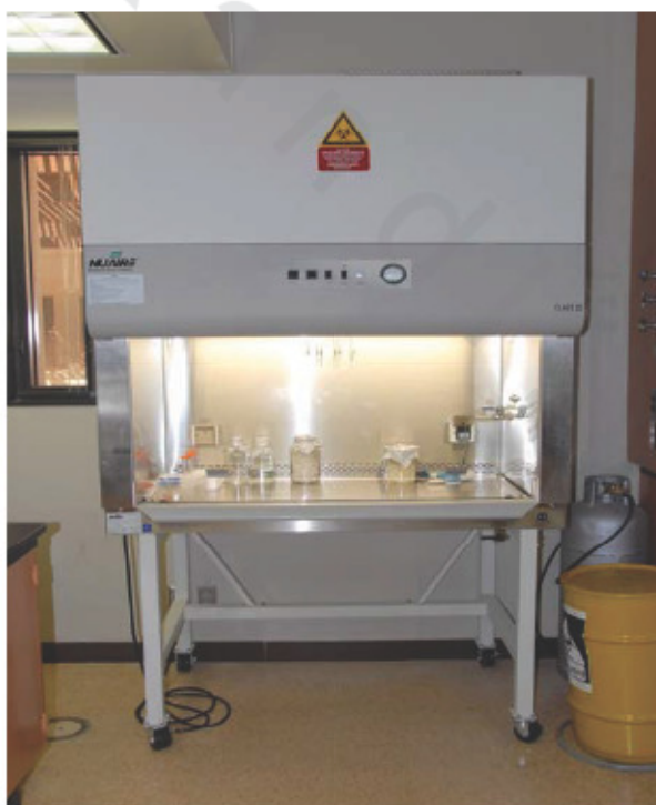
الشكل رقم (١٤). يوضح وحدة أو كابينة استخلاص ال DNA وتحضير محلول PCR
