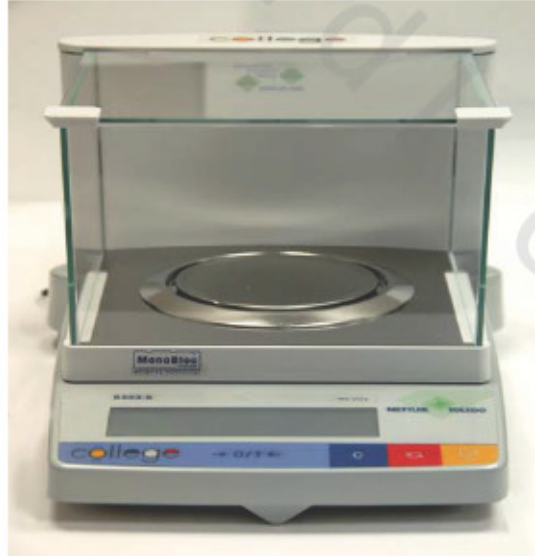
الشكل رقم (٤٢). يوضح الميزان الرقمى Digital balance لدراسة الجهد المائى للخليسة بتقدير تغير وزن النسيج النباتى.
