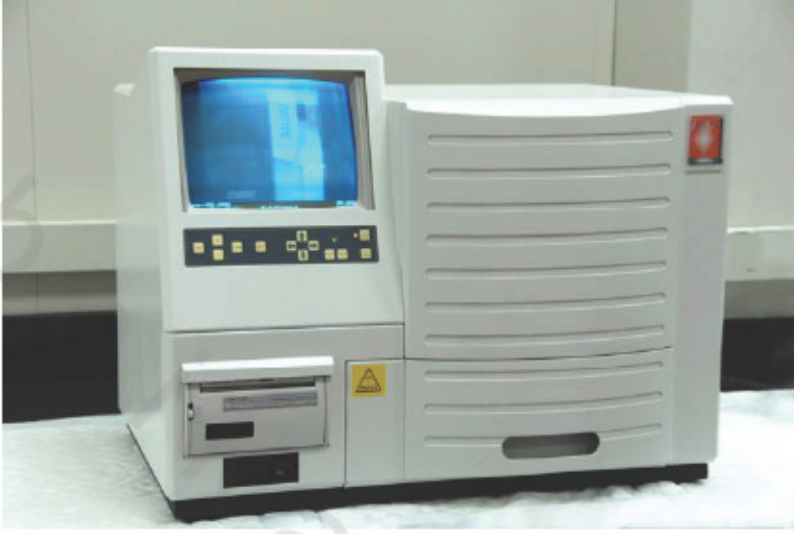
الشكل رقم ( ٢١ - أ ) . يوضح وحدة نظام تحليل الصورة الناتجة من التفريد الكهربائي.
