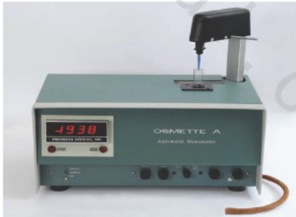
الشكل رقم (٥٣ - ب). يوضح جهاز الأسموميتر لقياس الجهد الأسموزي بطريقة انخفاض نقطة التجمد.
