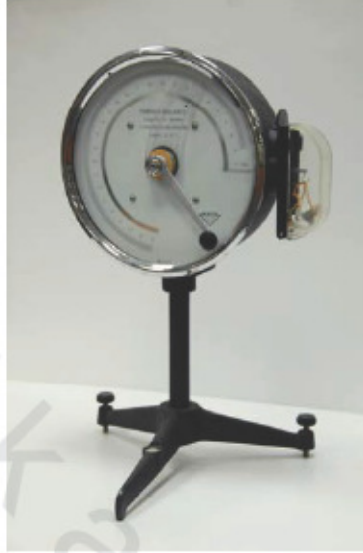
الشكل رقم (٥٠). ميزان تورشن Torsion لتقدير معدل النتح بطريقة الورقة المفصولة.
