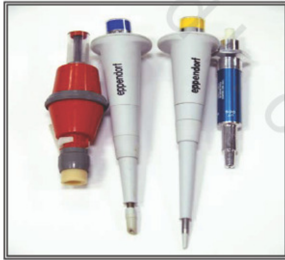
الشكل رقم (١٥-ب). يوضح نماذج مختلفة من الماصات الأوتوماتيكية لزوم بعض التجارب الفسيولوجية.
