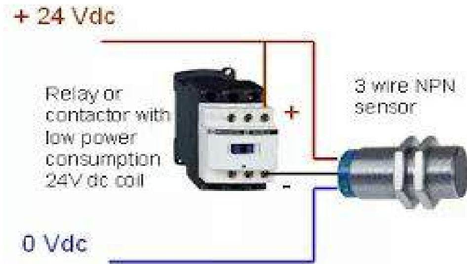
3 wire NPN wiring
