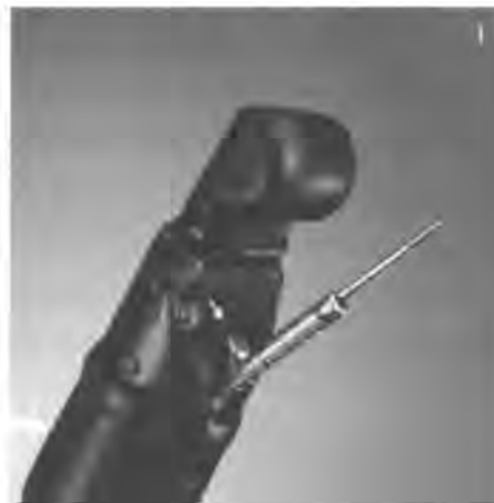
الشكل (٢) ذروة منظار صدوي يعمل بنظام المسح الخطي. وتظهر الصور الإبرة تخرج من قناة العمل
