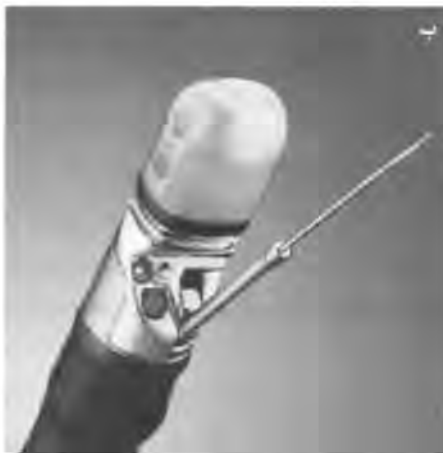
الشكل (٢) ذروة منظار صدوي يعمل بنظام المسح الخطي. وتظهر الصور الإبرة تخرج من قناة العمل
