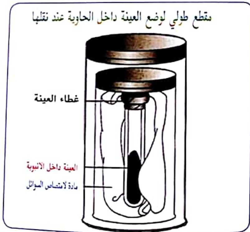
شكل (١٩٩) مقطع طولي لوضع العينة داخل الحاوية الثانوية (الصغيرة) عند نقل العينة
