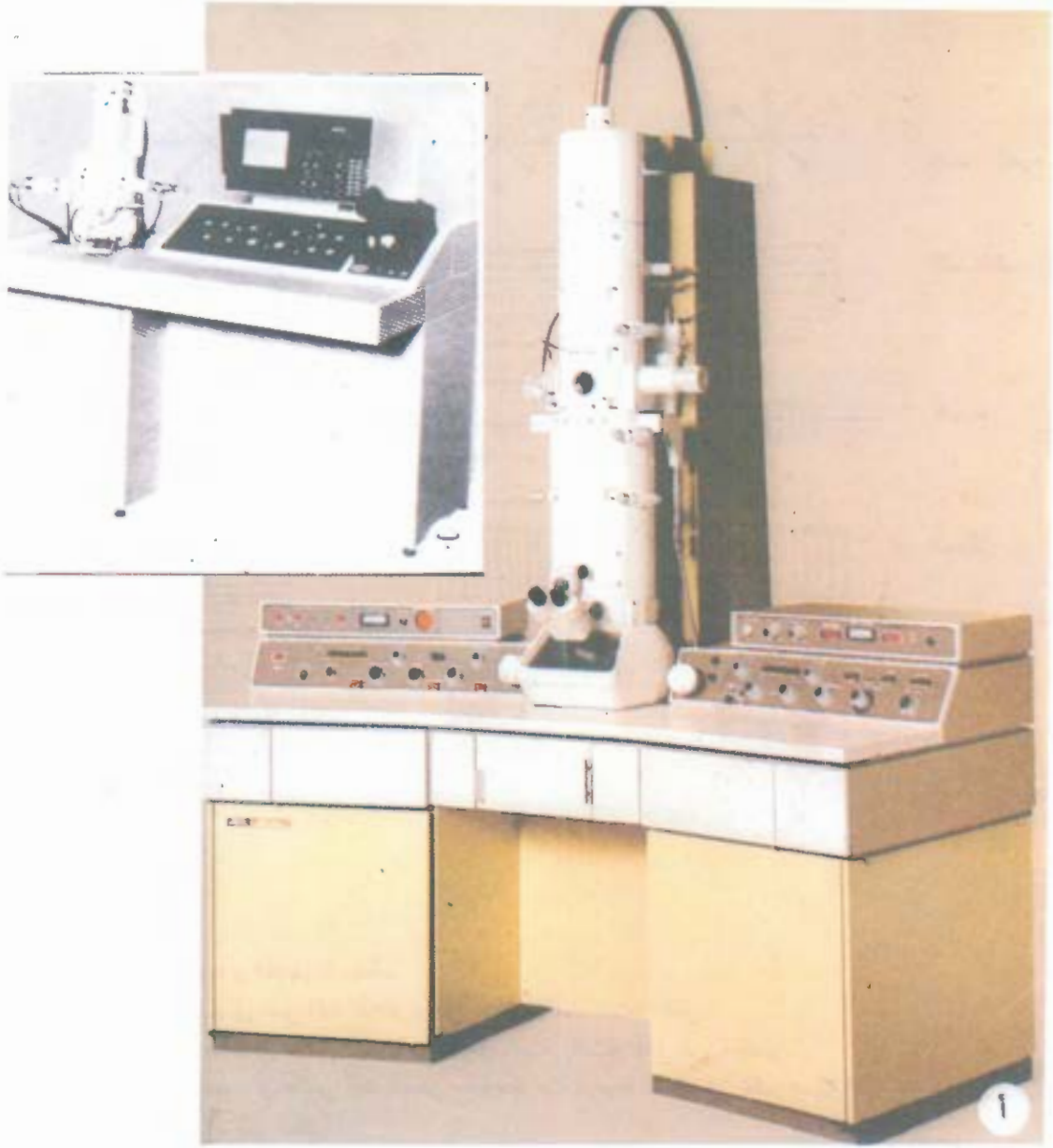
شكل (٦) المجهر الإلكتروني "Jeol" أ- النافذ ب- الماسح
