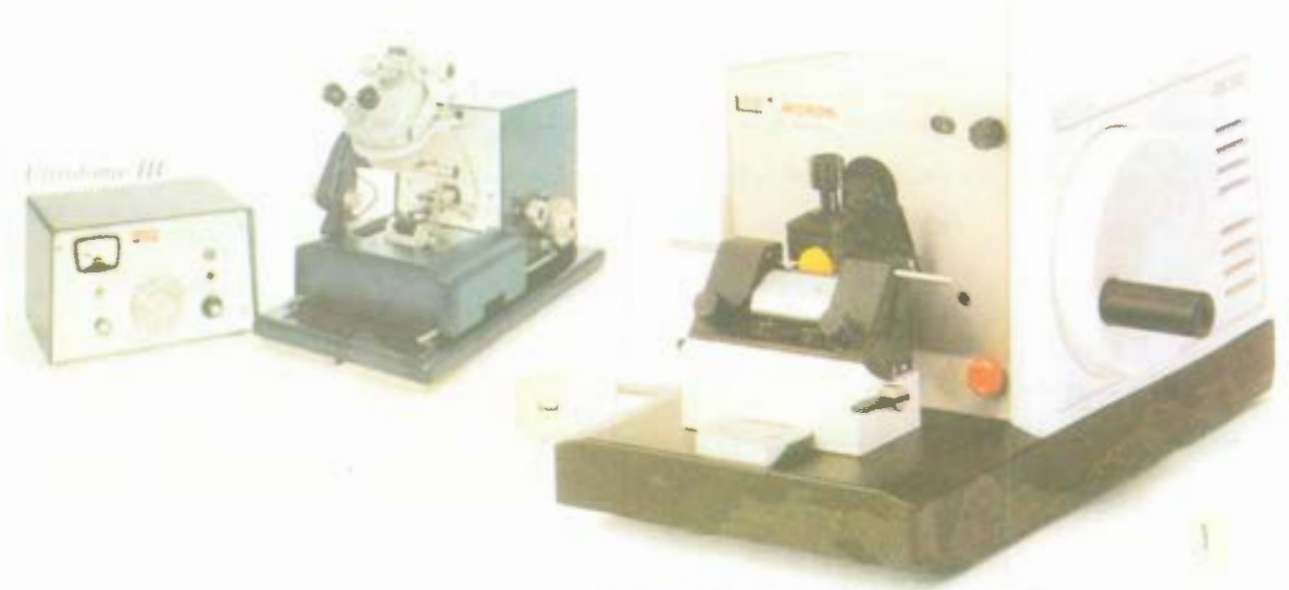
شكل (٧) المقطعات الدقيقة أ- المقطع الشمعي ب- المقطع فائق الدقة
