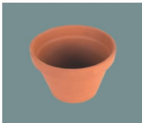
الشكل 12 كانت مواد الخزفيات العذبة تُصنع من الطين الذي يتم تسخينه للوصول إلى مادة قوية وصلبة.
