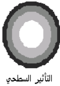
شكل (٣ - ٤) - توزيع التيار في الموصل نتيجة للتأثير السطحي والتأثير التجاوري
