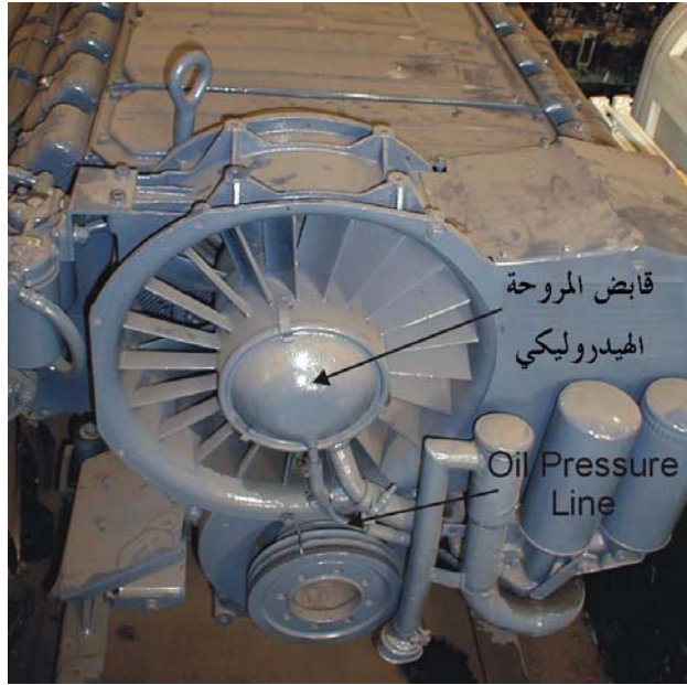
شكل ٤ - ٢٦: مروحة تبريد متغيرة السرعة لمحرك تبريد هواء
