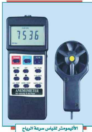
الأنيمومتر لقياس سرعة الرياح
