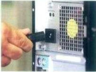
شكل (1-1-2) فصل التيار الكهربائي عن جهاز الحاسب الشخصي
