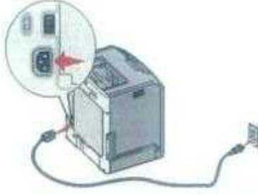
شكل (٢-٢-٢) توصيل الطابعة بمصدر التيار الكهربائي
