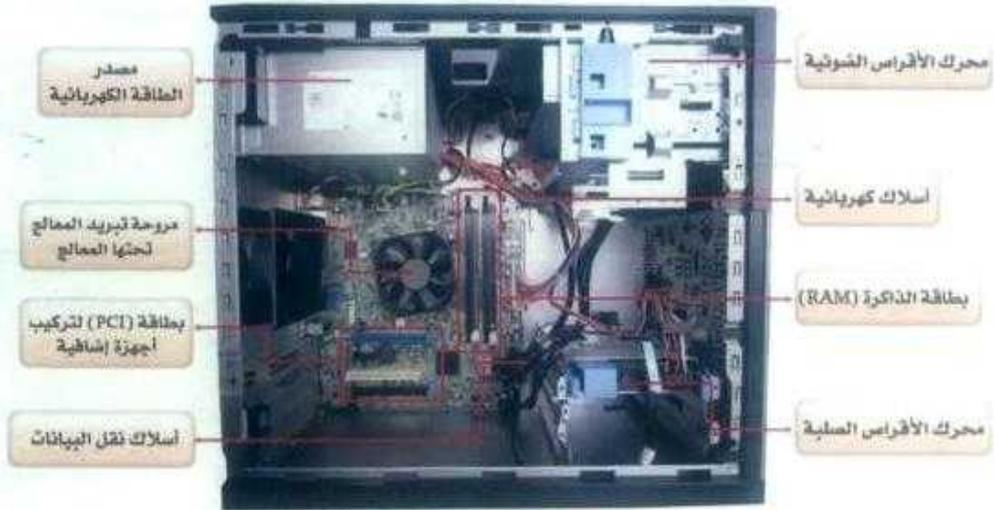
شكل (٥-١-٢): المكونات الداخلية لجهاز الحاسب
