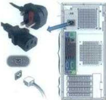
شكل (٢-١-١٠): توصيل سلك الكهرباء الخاص بصندوق الحاسب إلى مصدر التيار الكهربائي
