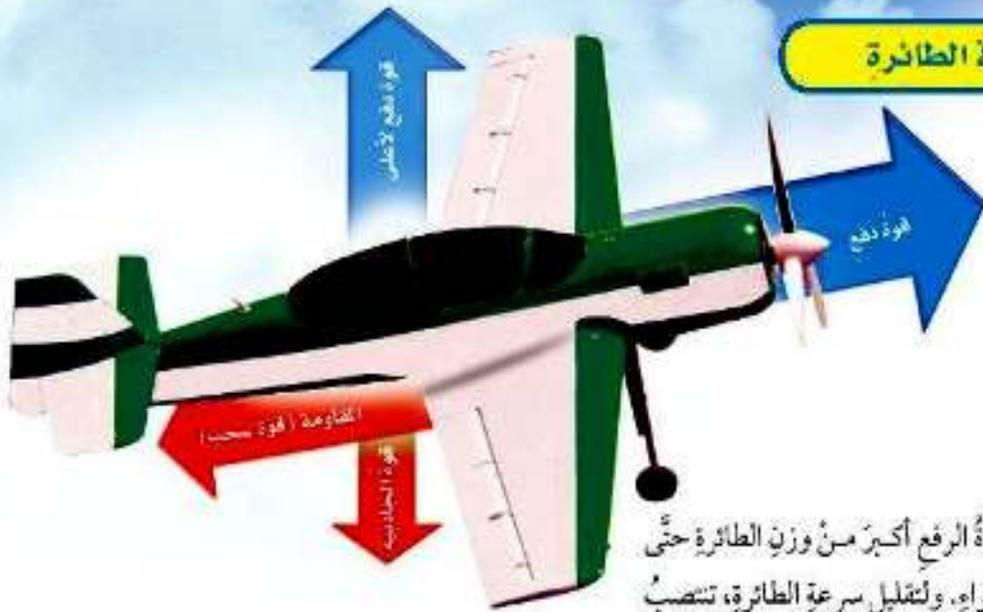
ويجب أن تكون قوة الرفع أكبر من وزن الطائرة حتى ترتفع الطائرة في الهواء. ولتقليل سرعة الطائرة، تنصب قطع فلزية مسنونة وعريضة فتصطدم بالهواء مما يسبب إبطاء حركة الطائرة. وتسمى هذه القوى قوى المقاومة، وهي قوى سحب تعيق حركة الطائرة.
