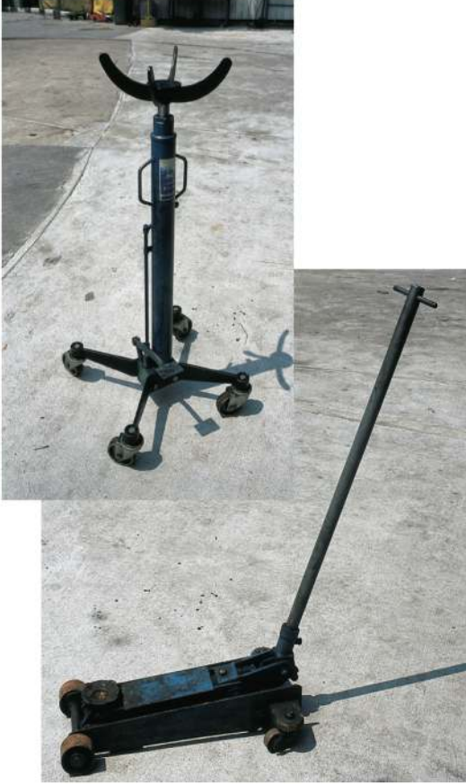
شكل 7-14 الرافع الهيدروليكية للسيارة
