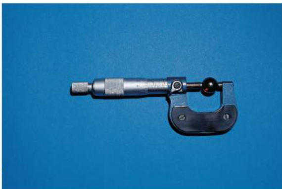
شكل 1 - 7 المقياس ذو اللولب الميكرومتر
