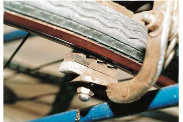
شكل 3 - 23 يسبب الاحتكاك تآكلًا للأجزاء المتحركة في الآلات
