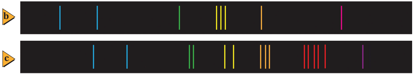
■ الشكل 4-2 يمكن استخدام منشور المطياف لمشاهدة طيف الانبعاث (a). طيفا الانبعاث الخطي للزئبق (b) وللباريوم (c) يظهران بخطوط مميزة.
