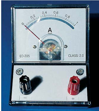
شكل 2-2 يقيس الأميتر شدة التيار الكهربائي
