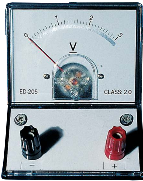
شكل 2-12 يقيس الفولتيمتر القوة الدافعة الكهربائية أو فرق الجهد
