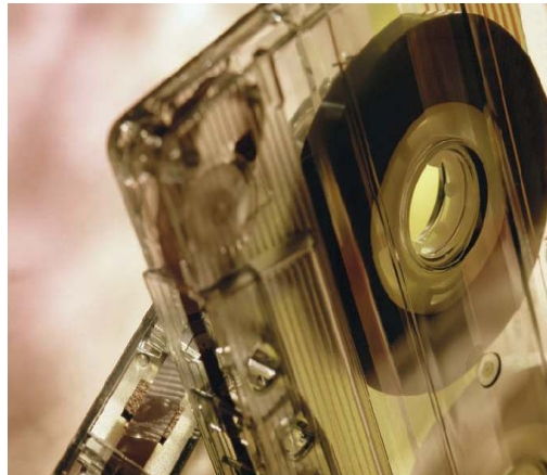
شكل 5 - 37 توجد طبقة من مادة مغناطيسية حديدية على الأشرطة السمعية والبصرية
