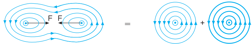
شكل 6-7 (ب) توحيد مجالات مغناطيسية نتيجة تيارات في نفس الاتجاه.
