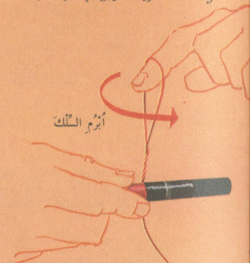
(٦) أُبْرَمِ نُقْطَةَ التَّفْرِيعِ بِوَضْعِ إِبْصِيعِكَ فِي الْأَنْشُوطَةِ - مُتَمَسِّكًا قَضِيبَ الْفِرَايْتِ ، فَوْقَ اللَّفَّاتِ الْخَمْسِ وَأَصْلِ الْأَنْشُوطَةِ ، بِالسَّبَابِغَةِ وَالْإِبْهَامِ مِنَ الْيَدِ الْأُخْرَى .
