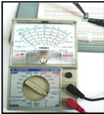
الشكل رقم (3 - أ) تحديد أطراف الثايرستور
