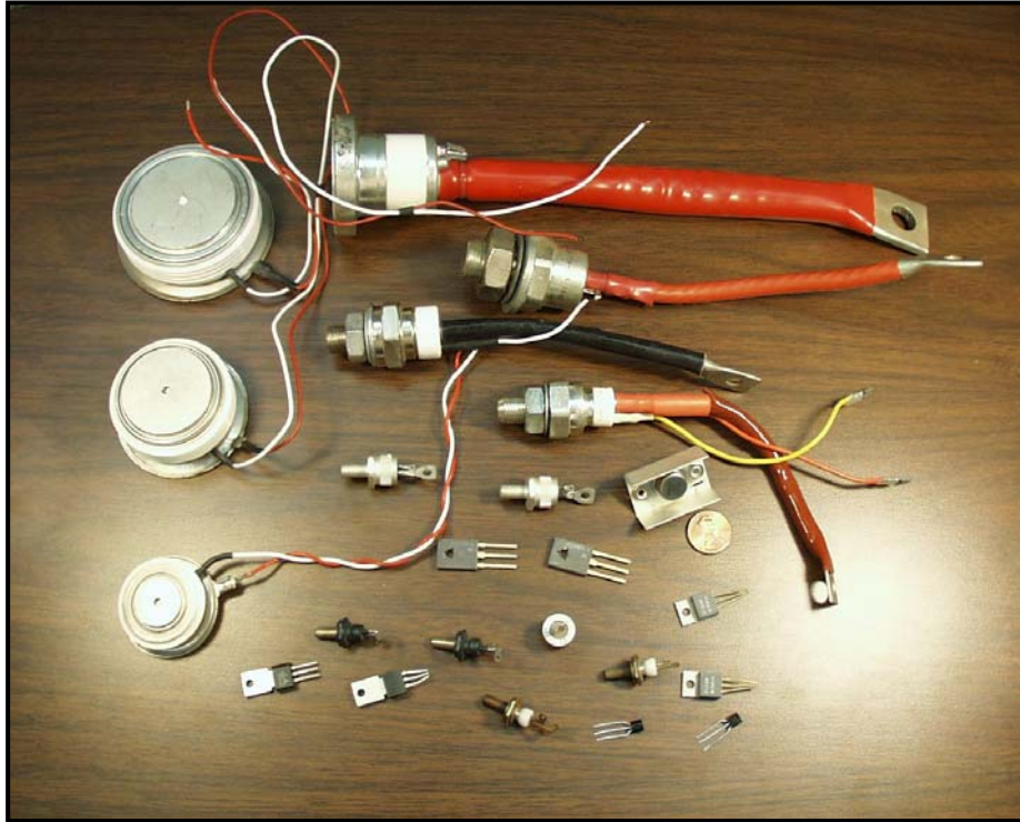
الشكل رقم (4) أشكال وأنواع الثايرستورات
