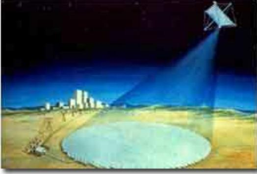
يقوم بتجميع الطاقة الشمسية وتحويلها إلى كهرباء ثم توجيهها نحو الأرض في شكل موجات متناهية الصغر "Microwaves" أو أي شكل آخر من أشكال نقل الطاقة. ومن مزايا هذه الفكرة أن الطاقة المنتجة لن يكون لها تأثيرات علي الاحتباس الحراري لكن الجانب الغير مرغوب هو أن الموجات المتناهية الصغر ربما تؤثر علي صحة الإنسان، و هذه الفكرة ربما لا تعتبر عملية في الوقت الراهن وربما لقرن قادم، ولكن من يدري؟.
