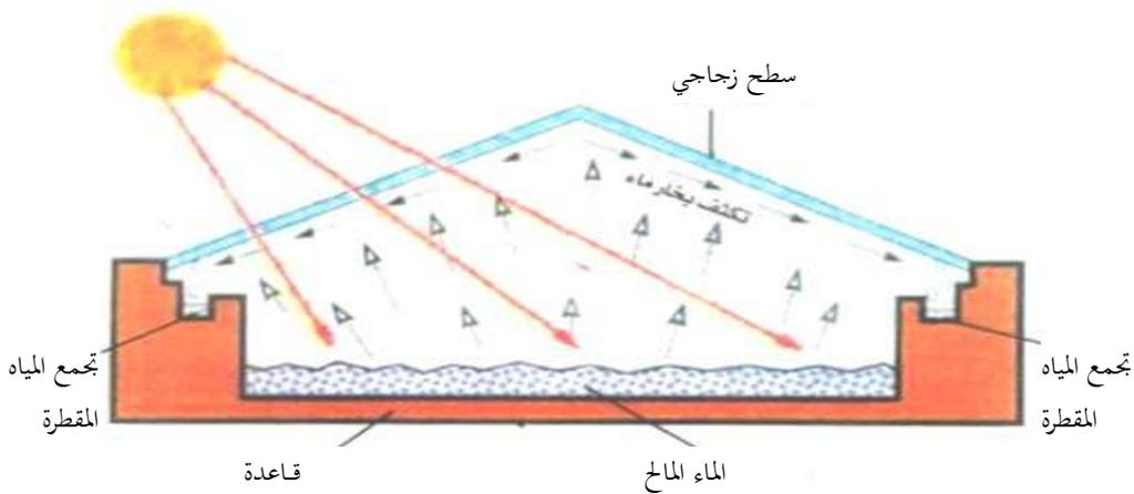
شكل (٢٨): رسم تخطيطي مبسط للمقطرات الشمسية الحرارية
