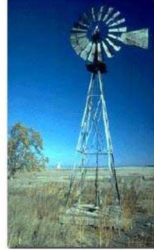
شكل (٣١): توربينة رياح تستخدم في ضخ المياه
