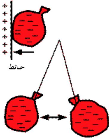
شكل (٧): رسم تخطيطي لإكتساب الشحنات الكهربائية الساكنة
