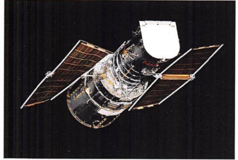
التليسكوب الفضائي "هبل" (Hubble) يحصل على التيار الكهربى من الخلايا الشمسية.
