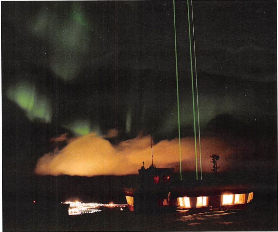
مرصد ومركز بحوث الغلاف الجوى فى جزيرة "أند أوى" (جزيرة البط) النرويجية ومنه ترسل أشعة الليزر لدراسة الغلاف الجوى (K.Dahle / ARS).
