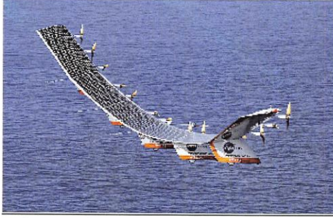
طائرة تعتمد فى طيرانها على الكهرباء التي تستمدتها بالكلية من الخلايا الشمسية، بنتها "ناسا" (NASA)
