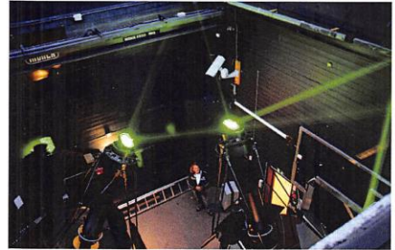
باستخدام أشعة ليزر قوية وجهاز رادارى حساس يمكننا معرفة بعض خواص الغلاف الجوى ( G.Baumgarten )
