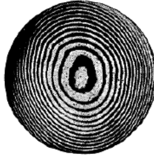
الشكل 146: حلقات نيوتن بواسطة ضوء الصوديوم.
