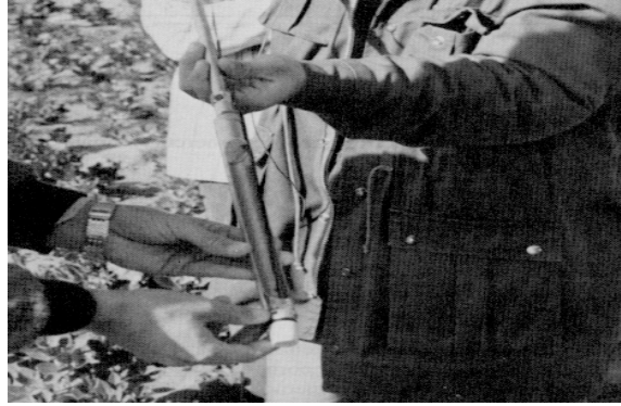
شكل رقم (٣.١١). تركيب المكعبات الجبسية البيضاء باستخدام مسبار "أو كفيلد" للتربة. تمر الأسلاك إلى المكعبات من خلال فتحات عند نهاية المسبار أثناء دفع المكعبات إلى قاع الحفرة المعدة سلفاً.
